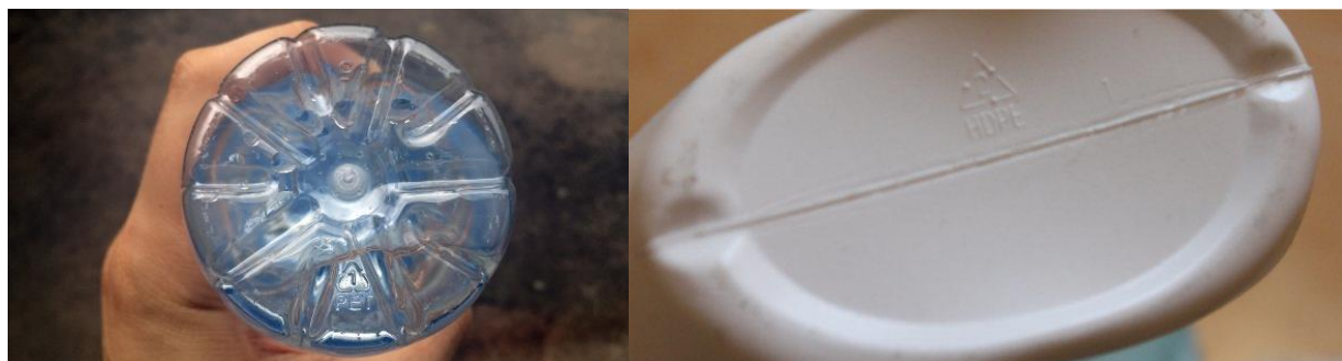
Рисунок. Отличительная особенность упаковки ПЭТ и ПНД
